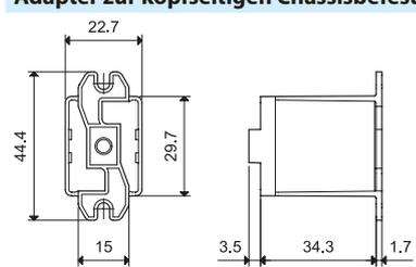
Der elektrische Anschluss erfolgt durch Lötens und einer Schrumpfschlauch-Isolierung oder über isolierte Steckhülsen für (2 x 0.5)mm Faston.
