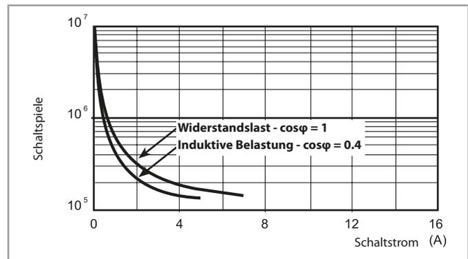
**H 55 - Gleichstromschaltvermögen bei DC1 - Belastung**
