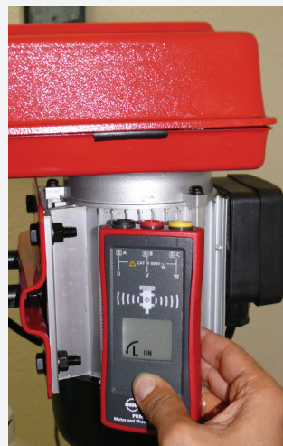
Kabellose Prüfung der Motor-Drehrichtung
