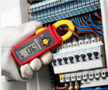
**Fehlersuche in elektrischen Anlagen** und Messung von Strömen im Gleich- und Wechselstrombereich an freiliegenden Leitungen in einem Leistungsschalterfeld.
