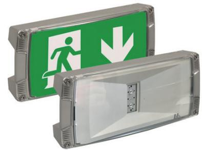
Das Sortiment enthält Sicherheitsleuchten mit unterschiedlichen Optiken für die Fluchtweg- oder Raumausleuchtung und ein- oder doppelseitige Rettungszeichen mit einer optimalen Erkennbarkeit, die durch die hohe Leuchtdichte der weißen Kontrastfarbe (>500 cd/m<sup>2</sup>) erreicht wird. Atlantic LED eignet sich für den Einsatz in lebensmittelverarbeitenden Betrieben mit Anforderungen gemäß IFS und HACCP.
