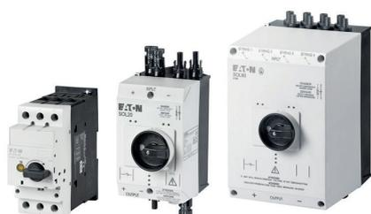
Der ungekapselte P-SOL und gekapselte Lasttrennschalter SOL von Eatons Moeller Series wird als DC-Trennstelle in Photovoltaiksystemen zwischen PV-Generator und Wechselrichter zum Abschalten der Energie angewendet. Der P-Sol ist ausgelegt für Betriebsströme von 20 A, 30 A (26 A) und 60 A bis zu 1000V DC und ist somit sehr vielseitig nutzbar. Mit ihrer vorverdrahteten, sofort einsatzbereiten Funktionalität und ihrem IP65-Gehäuse sind sie auch ideal für den Einsatz im Freien geeignet.
